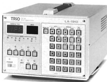
**Strumento per verificare il funzionamento di un sistema IEEE-488.**
