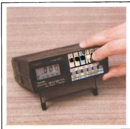
Le portate e le funzioni vengono scelte premendo con la punta delle dita i vari pulsanti la cui individuazione è facilitata mediante vivaci colori.
