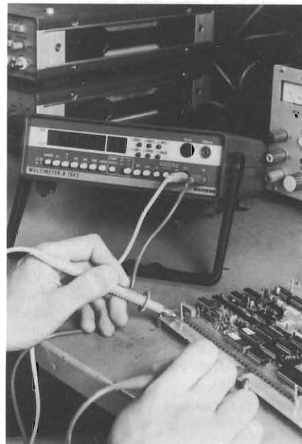
**Il multimetro B 1042 della Siemens è un apparecchio di misura a microprocessore con funzioni di calcolo integrate per elaborare valori di misura ricorrenti. Il campo di misura può essere scelto a mano o automaticamente.**
