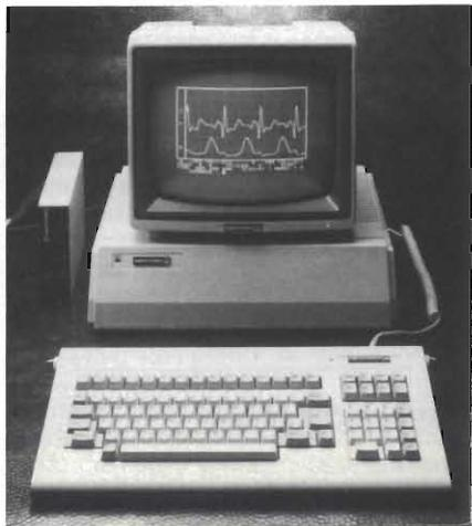
**Lab Scopio e funzioni molteplici; include un oscilloscopio digitale di memoria, stabilizzatore di segnali, analizzatore di spettro, forma d'onda e istogramma, autocollettore, DVM spazzolamento molteplice, ecc.**
