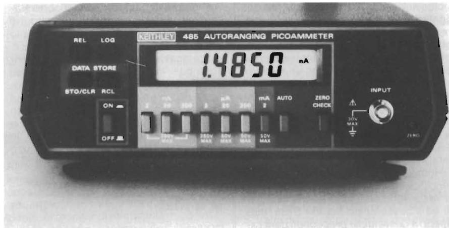
**Picoamperometro digitale ad autocommutazione di scala (sensibilità 0,1 pA), interfacciabile opzionalmente in IEEE-488 per personal computers.**
